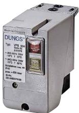
“泄漏检测装置”用于检查燃气阀组阀门的密封情况。根据 EN 676 标准，最大出力大于 1200 kW 的燃烧器强制安装阀门泄露检测装置。该泄露检测装置的型号为 VPS 504。
