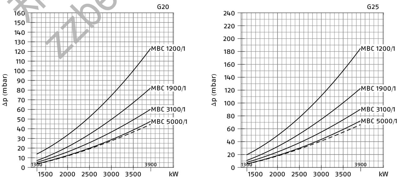
— 燃烧头 + 燃气蝶阀 + 燃气阀组
