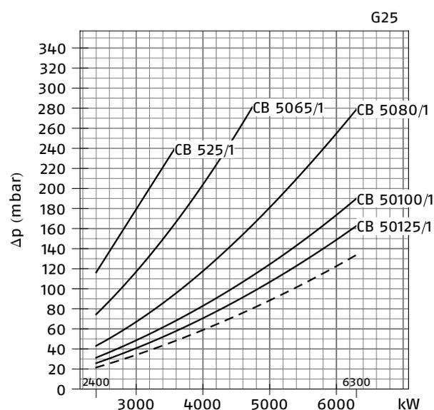
— 燃烧头 + 燃气蝶阀 + 燃气阀组
